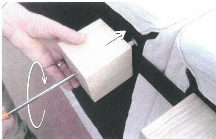
6) Avvicinare gli elementi e riavvitare i piedi facendo passare la vite per il foro della piastra di collegamento.
