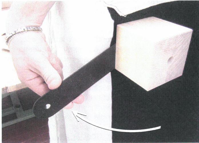
4) Ruotare la piastra di collegamento di 90° e fissarla stringendo di nuovo la vite.
