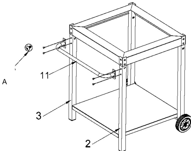
Stecken Sie den Handgriff (11) auf das linke vordere Bein (2) und das linke hintere Bein (3) befestigen Sie den Handgriff mit M6\*12 Schrauben (A).
