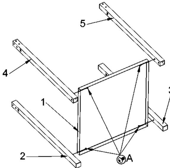
1-1: Montieren Sie das linke vordere Bein (2) an die Ablage (1) mit einer M6x12 Schraube (A);
