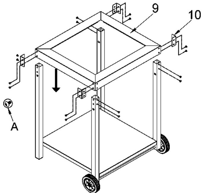
Stecken Sie den Oberen Rahmen (9) auf die oberen Beinenden (wie aufgezeichnet). Stecken Sie die Winkel (10) auf den oberen Rahmen (9). Befestigen Sie die Winkel mit 6\*12 Schrauben (A) Handfest angezogen.
