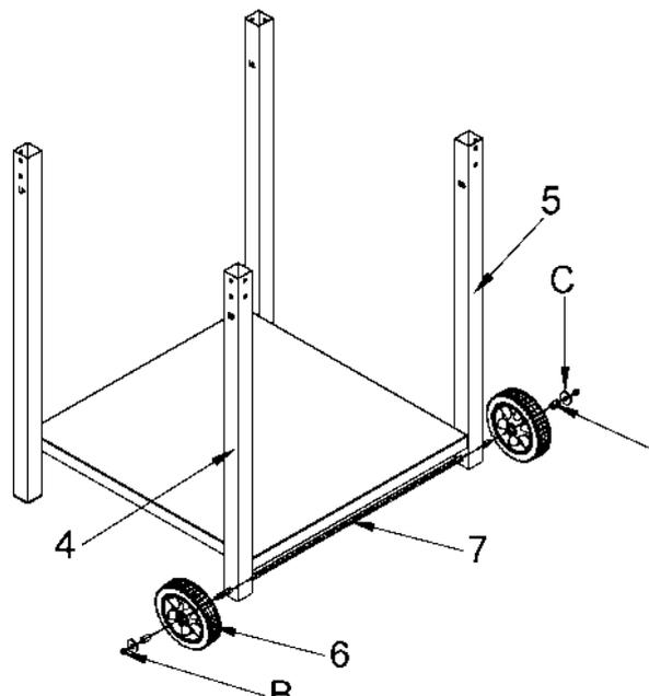
Stecken Sie die Achse (7) durch die beiden Beine (4 and 5), Stecken Sie das Rad (6) und die Hülse (8) inklusive der Unterlagsscheibe (C) auf die Achse, Ziehen Sie zwei M6 Kontermuttern (B) auf jedes Ende und ziehen Sie diese mit einer Ratsche an. Das Rad sollte sich drehen aber nicht eiern.
