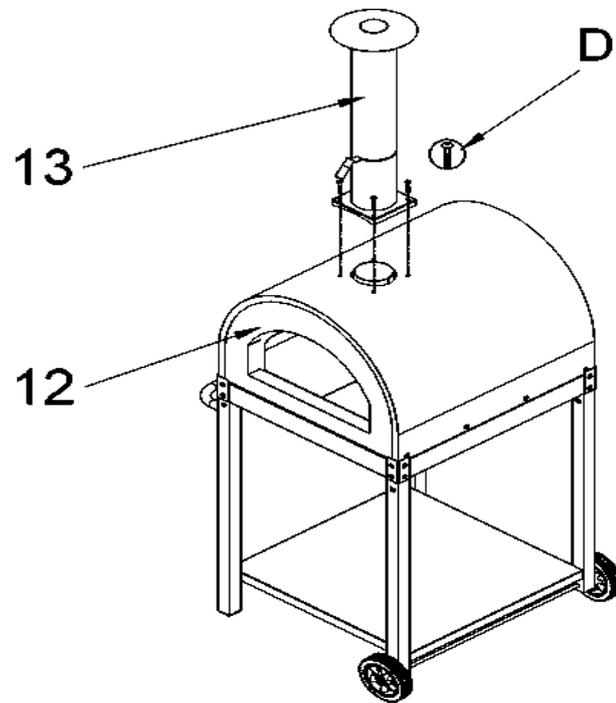
Stecken Sie das Kamin (13) auf den Ofen (12) Schrauben Sie das Kamin mit M6\*38 Schrauben an (D).
