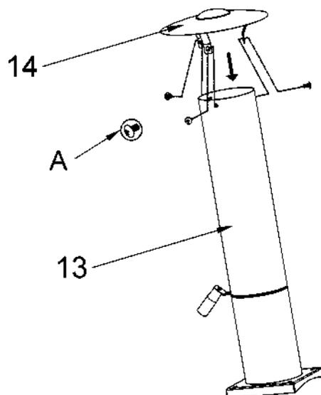
Stecken Sie die Kaminabdeckung (14) auf das Kamin (13) befestigen Sie die Abdeckung mit M6\*12 Schrauben (A).
