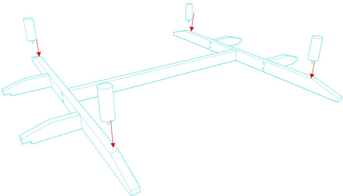
Den Unterbau drehen und die 4 Füsse montieren.
