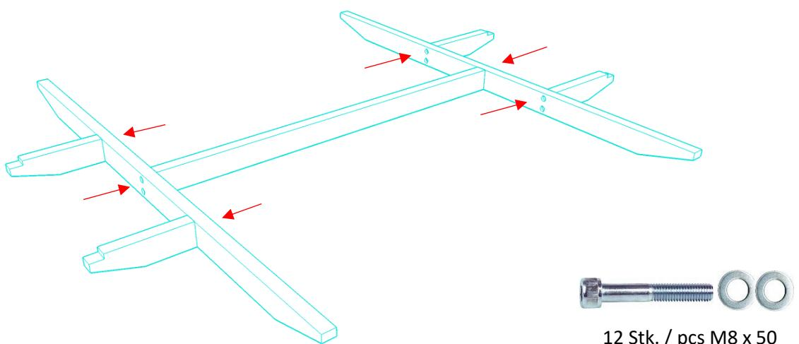
Längs- und Quertraversen verschrauben.
