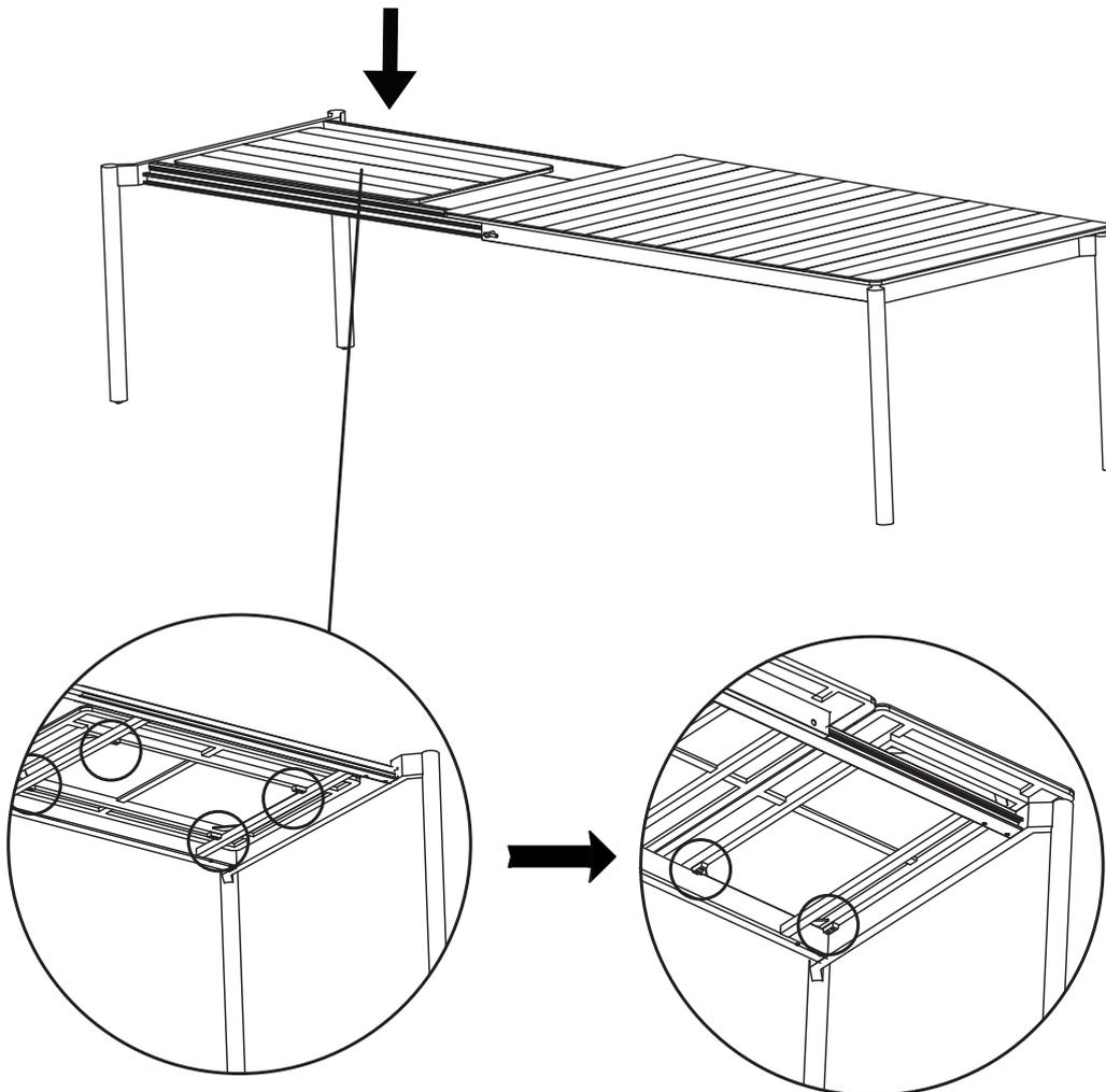
Bei Nichtgebrauch kann die Verlängerung innerhalb des Tisches auf dem Verlängerungsrahmen gelagert werden. Achten Sie bitte darauf, dass die Gleiter unter der Verlängerung an beiden Enden zwischen den Querstangen liegen. Dadurch wird verhindert, dass die Verlängerung verrutscht und herausfällt.
