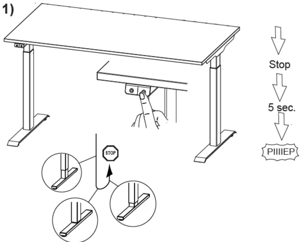
Sollte der Tisch dann doch nicht funktionieren, sollte das System in die Werkseinstellung zurückversetzt werden.
