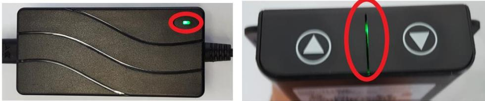
Für den Betriebszustand muss die „ab“ Taste gedrückt und gehalten werden bis der Tisch ganz nach unten gefahren ist und ein wenig hoch (ca. 1cm). Danach ertönt ein kurzes Signal. Erst jetzt kann die „ab“ Taste losgelassen werden. Nun ist der Tisch Betriebsbereit.
