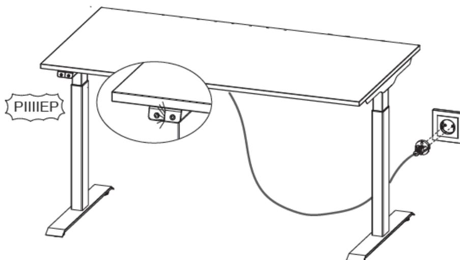
2. Wenn **alle Stecker** angeschlossen sind und der Tisch mit Strom versorgt ist, muss im Anschluss der Betriebszustand hergestellt werden.
