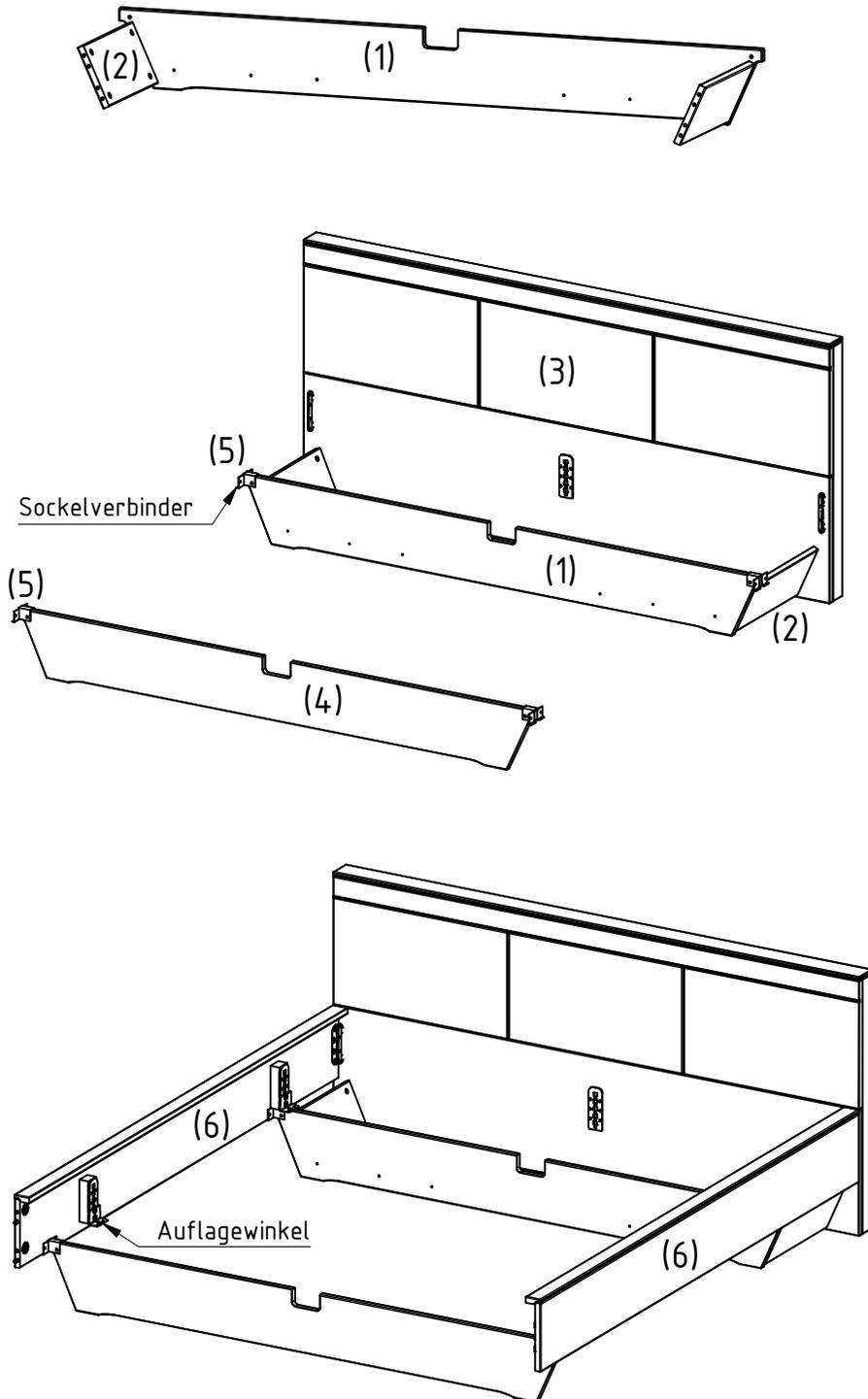
1. Bettkopfteilblende (1) mit den 2 Bettseitenblenden (2) verbinden (4x Minifix Beschlag komplett, 4 Holzdübel 8x30mm)
