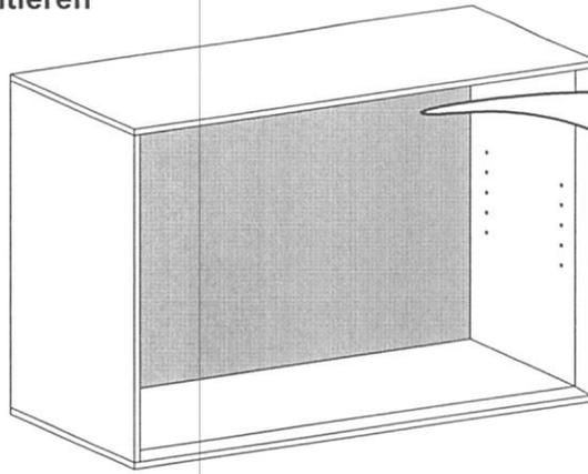
Befestigung mittels Magnetstreifen
