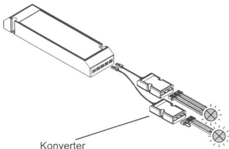
Bei der Verwendung eines Funkschalters muss zwischen Trafo und Beleuchtungselement bzw. Konverter ein Funkempfänger angeschlossen werden.
