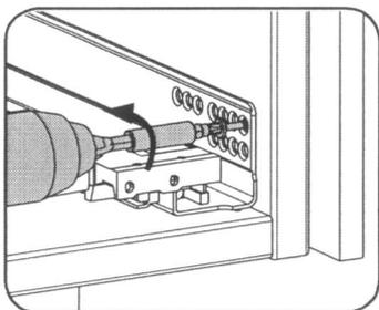
9. Seitenteil montieren mit Gestaltungselement außen
