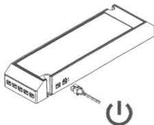
Bei der Verwendung von mehr als einem Trafo die miteinander geschaltet werden sollen ist ein Multi-Netzteil von Nöten.
