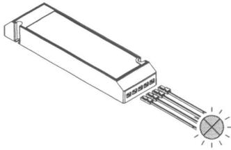
Bei mehr als 6 Beleuchtungselemente muss ein Verteiler verwendet werden.
