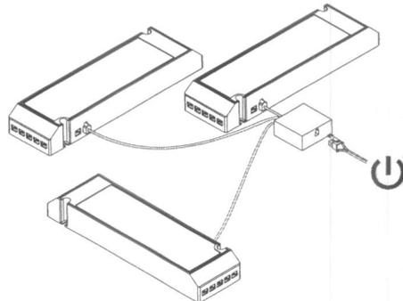
4.4 Bei der Verwendung eines Wandschalters ist eine geschaltene Steckdose zu verwenden.
