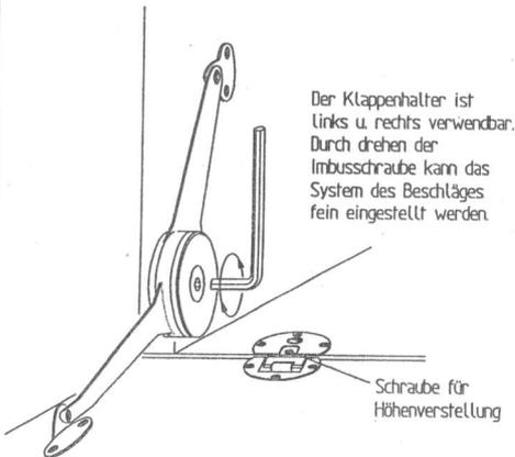
Der Klappenhalter ist links u. rechts verwendbar. Durch drehen der Imbusschraube kann das System des Beschläges fein eingestellt werden.
