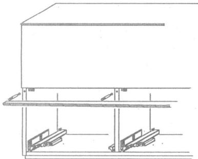
Minifix Gehäuse in die vorgesehenen Löcher stecken.
