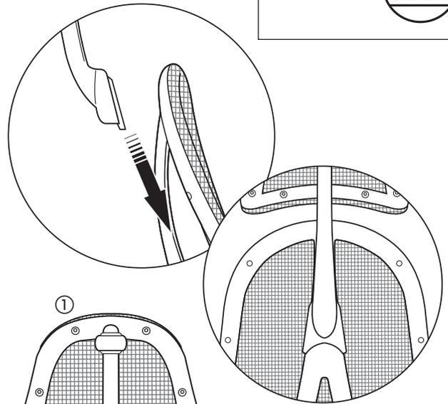
**D** **ACHTUNG!** UM DIE KOPFSTÜTZE ZU MONTIEREN SCHIEBEN SIE DIESE VON OBEN AUF DEN RÜCKENLEHNENBÜGEL BIS ZUM ANSCHLAG NACH UNTEN DURCH.
