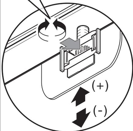
Spannbeschlag ab 1400mm Türhöhe.
