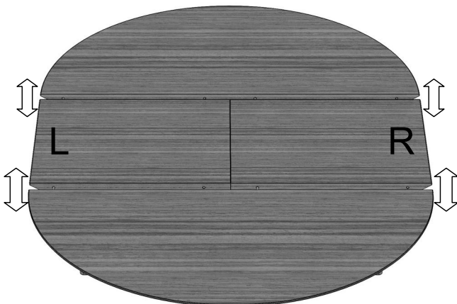
11. Prüfen, ob die Oberkanten des Auszugs und die Hauptplatten außen auf einer Höhe sind. Nur wenn nicht ... 11. Check in the middle if the upper surfaces of the boards and the extension are on one level. Only if not ...
