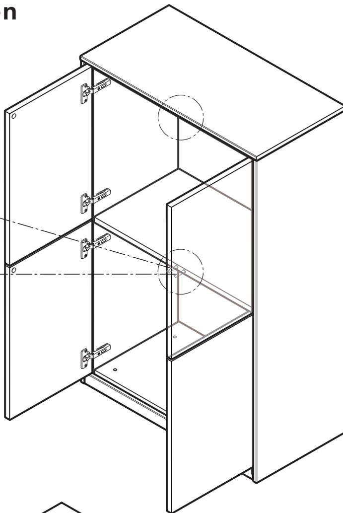
Bei Klappen mit zwei Auswerfern diese immer synchron (=) einstellen.
