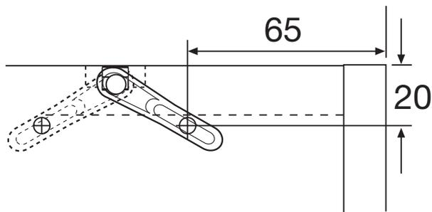
1.) Kippsicherung so anschrauben das ein verstellen noch möglich ist. Falls notwendig, kann das Rastelement (K1) z.B. mit einem Seitenschneider gekürzt werden.
