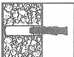
Beiliegendes Befestigungsmaterial eignet sich nur für Massivwände.
