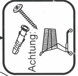
Schublade mit 3x20mm schrauben an die Unterführungsschiene befestigt
