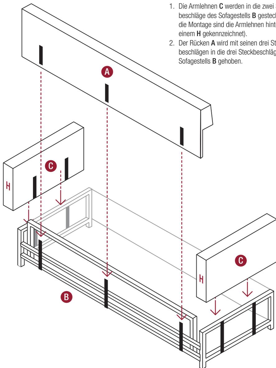
1. Die Armlehnen **C** werden in die zwei Steckbeschläge des Sofagestells **B** gesteckt (für die Montage sind die Armlehnen hinten mit einem **H** gekennzeichnet).
