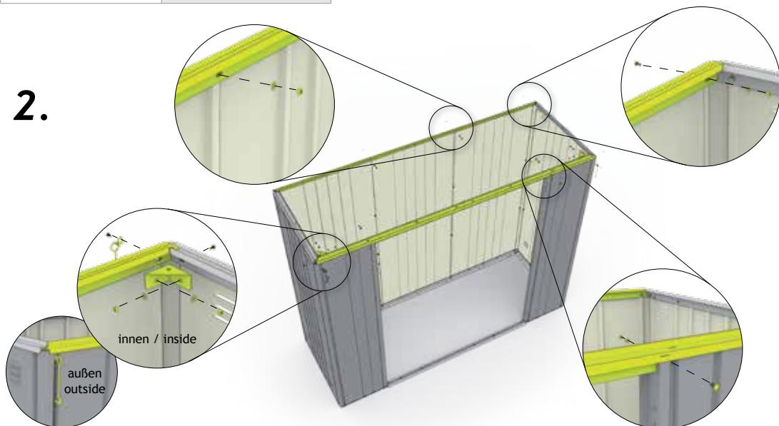
Größenabhängiger Montageschritt - Size-Dependent assembly step - Dépendant de la taille - Size-Dependent montagestep
