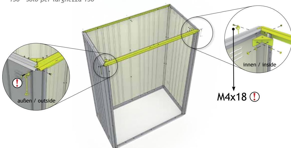
Size-Dependent assembly step - Paso de montaje de tamaño Dependiente - Taglia-Dependent fase di montaggio
