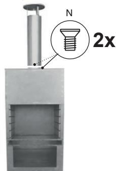
Deckel mit Schrauben befestigen.
