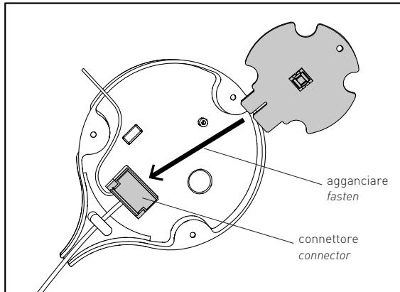
Inserire il nuovo circuito nel connettore applicando una lieve pressione.
