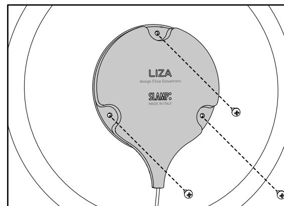
Una volta bloccato il circuito LED richiudere il coperchio protettivo serrandolo con le viti
