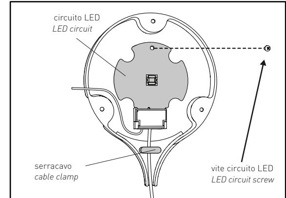
Svitare la vite del circuito LED.
