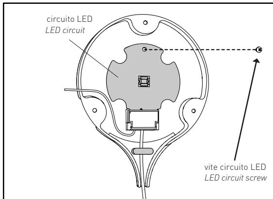
Bloccare il circuito LED al coperchio tramite la vite
