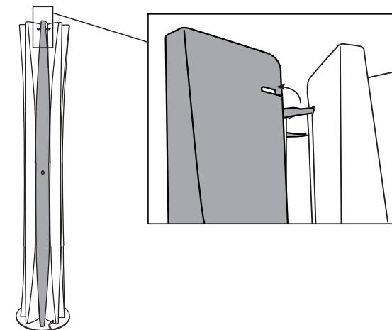
Per sostituire le lampadine sganciate la parte superiore dell'elemento con il cilindretto metallico come mostrato nell'ingrandimento sopra.
