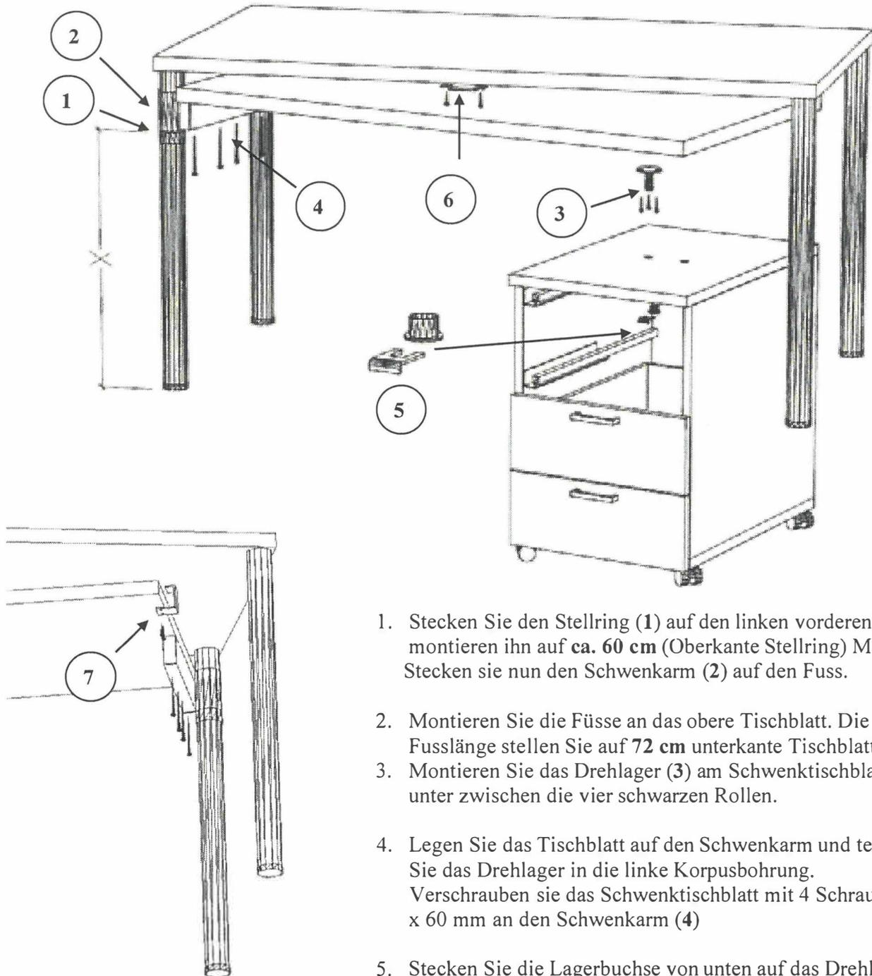
1. Stecken Sie den Stelling (1) auf den linken vorderen Fuss und montieren ihn auf **ca. 60 cm** (Oberkante Stelling) Mass **X**. Stecken sie nun den Schwenkarm (2) auf den Fuss.
