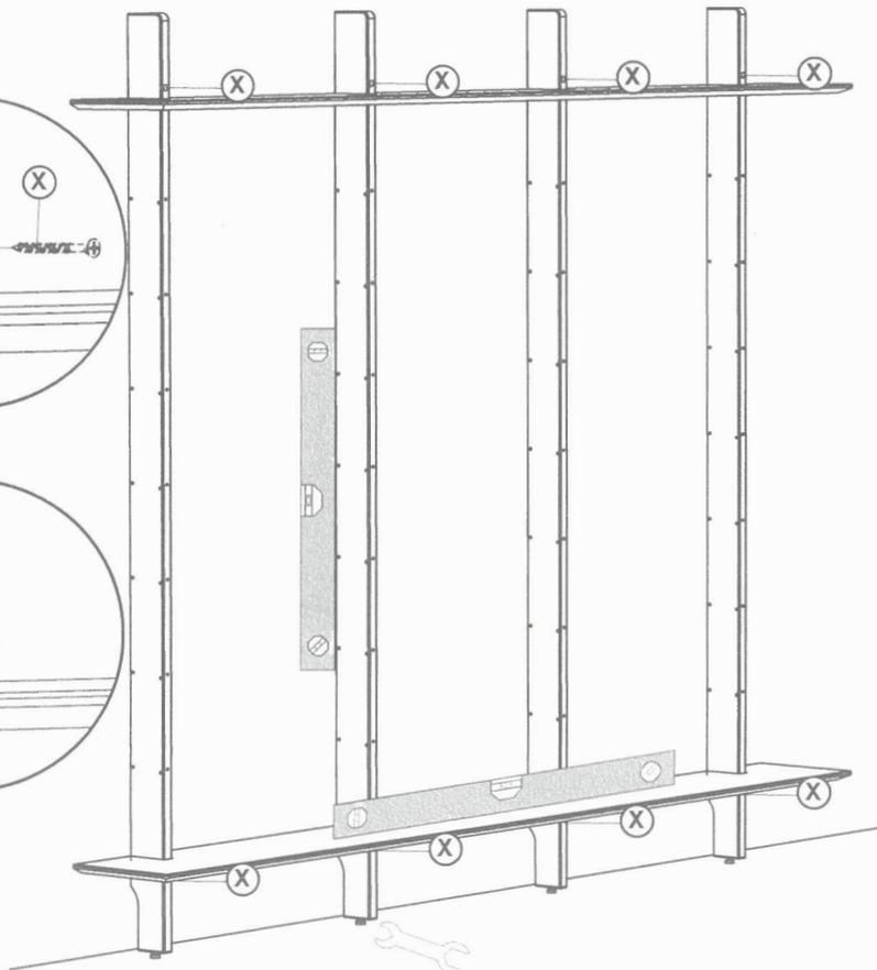
Var noga med att kontrollera väggens beskaffenhet före montering av produkten. Var vänlig använd lämplig plugg och skruv för din vägg. (ingår ej)
