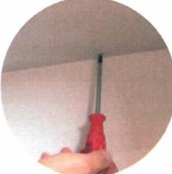
(1) Démonter les tiroirs et les portes. Insérez la ferrure de raccordement (A) par l'arrière et par le bas dans les trous prépercés du meuble.
