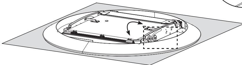
Hebel bis zum Anschlag drehen
