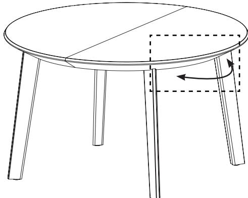
Hebel bis zum Anschlag drehen
