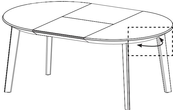
Hebel bis zum Anschlag drehen
