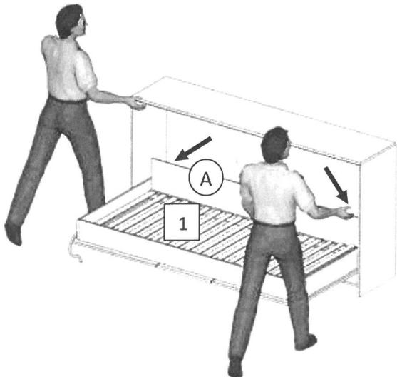
Öffnen Sie das Bett ganz, **sichern Sie das Bett dabei mit einer Person** oder fixieren sie den Korpus mit einem Spanngurt. Entfernen Sie die beiden Sprengringe (1.1), rechts und links hinter der Blende (A). Abb. 2, hängen Sie den Hebel (G) mit einem Schraubendreher aus.
